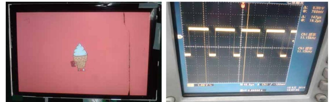
赤图像的时候：MIPI显示器的输出PWM duty cycle是72.73%
